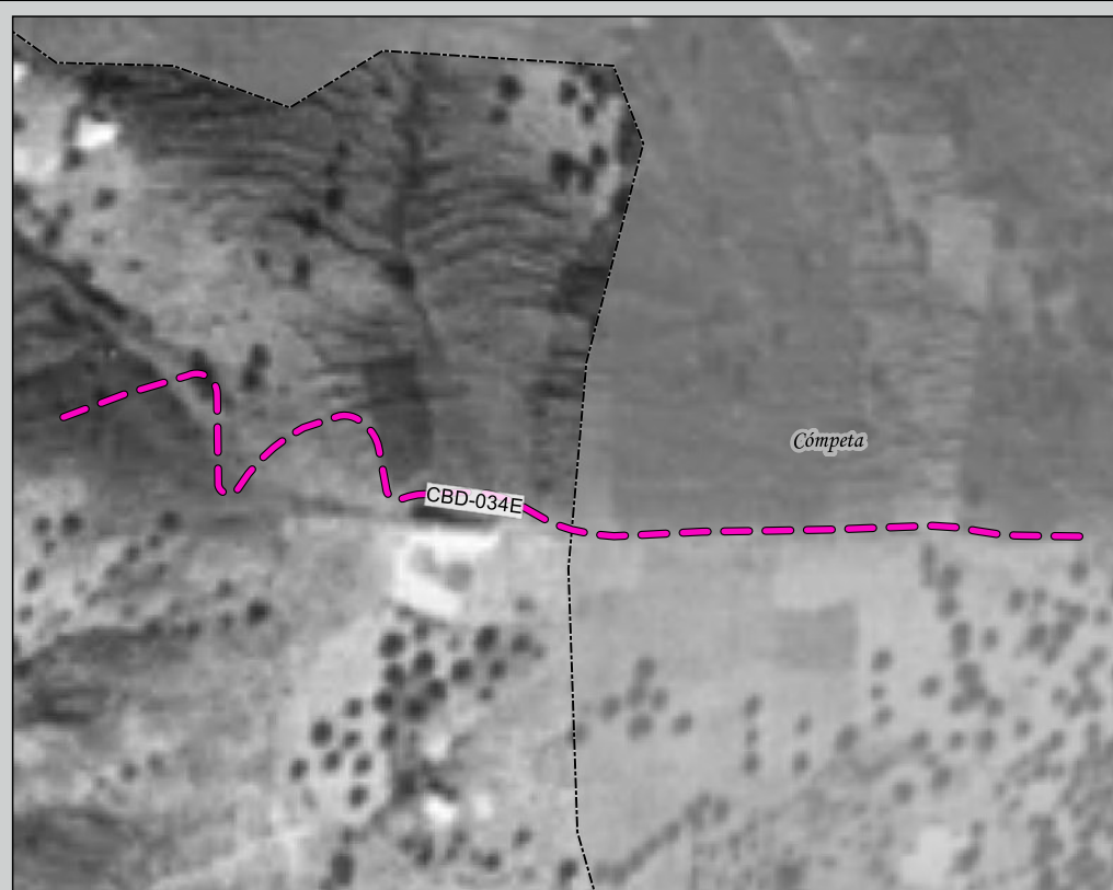
Ortofoto Digital Pancromática de Andalucía 1956-57. Ortofotografía de 1 m de resolución, generada a partir de vuelo fotogramétrico nacional blanco y negro a escala 1:33.000.
